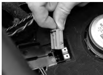
N°17. Déconnexion du connecteur d'origine
