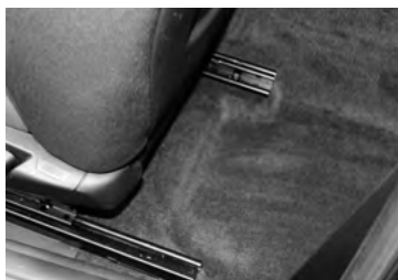
N°3. Localisation des vis "arrière" pour démonter le siège
