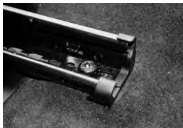
N°2. Localisation des vis "avant" pour démonter le siège
