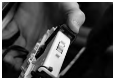
N°9. Déverrouillage du connecteur d'alimentation placé sous le siège*
