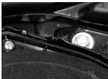
N°18. Si besoin et si opération de décollage du haut-parleur nécessaire, veuillez démonter les 2 vis de fixation du caisson
