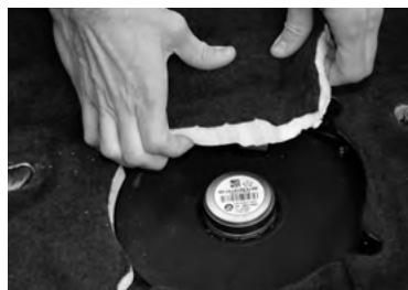
N°15. Enlevez la moquette qui recouvre le connecteur du subwoofer
