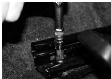
N°5. Dévissez à l'aide d'un embout "torx 45"
