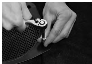
N°13. Démontage de la grille du plancher (4 vis)
