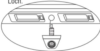
Führen Sie das Kabel und das Gewinde durch das Loch und befestigen die Kamera mit Scheibe und Mutter.
